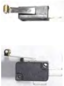
Mikroschalter/Wechselschalter mit langem Rollenhebel Max.Werte: 5A / 125 VDC / 250 VAC Max. Durchgangswiderstand: 30m Ω Min. Isolationswiderstand: 500 VDC / 100m Ω (L 28/ 38,6mm x H 15,8 mm x B 10,2 mm) Art.-Nr.: 8002.04 Preis pro Stück:
