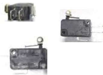
Mikroschalter/Wechselschalter mit kurzem Rollenhebel 1-polig (bh 412810-0001) (für Schrittgetriebe –Zahnriemenrad Überlastkupplung) Max.Werte: 5A / 125 VDC / 250 VAC Max. Durchgangswiderstand: 30m Ω Min. Isolationswiderstand: 500 VDC / 100m Ω (L 28/ 39mm x H 16/28mm x B 10mm) Bell+Howell PostStar XPO,XPV Art.-Nr.: 8002.03 Preis pro Stück:
