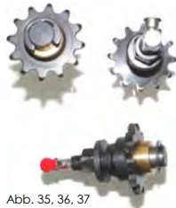
Abb. 35, 36, 37 Kettenrad kpl. 12 Z 06 C-1 DIN 8196 D= 1/2 (bh 054616-0001) mit Kettenrad (bh597042), Buchse G 1/2 G7x 3/4 R6x19,05, Kettenradachse (bh518967), Einschraubdeckelölter (bh546020) Bell+Howell CEXP/XPO/JPO Art.-Nr.: 8439 gebraucht Preis pro Stück:
