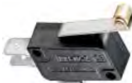
Mikroschalter/Wechselschalter mit langem Rollenhebel Max.Werte: 5A / 125 VDC / 250 VAC Max. Durchgangswiderstand: 30m Ω Min. Isolationswiderstand: 500 VDC / 100m Ω (L 28/ 38,6mm x H 15,8 mm x B 10,2 mm) Art.-Nr.: 8002.04 Preis pro Stück:
